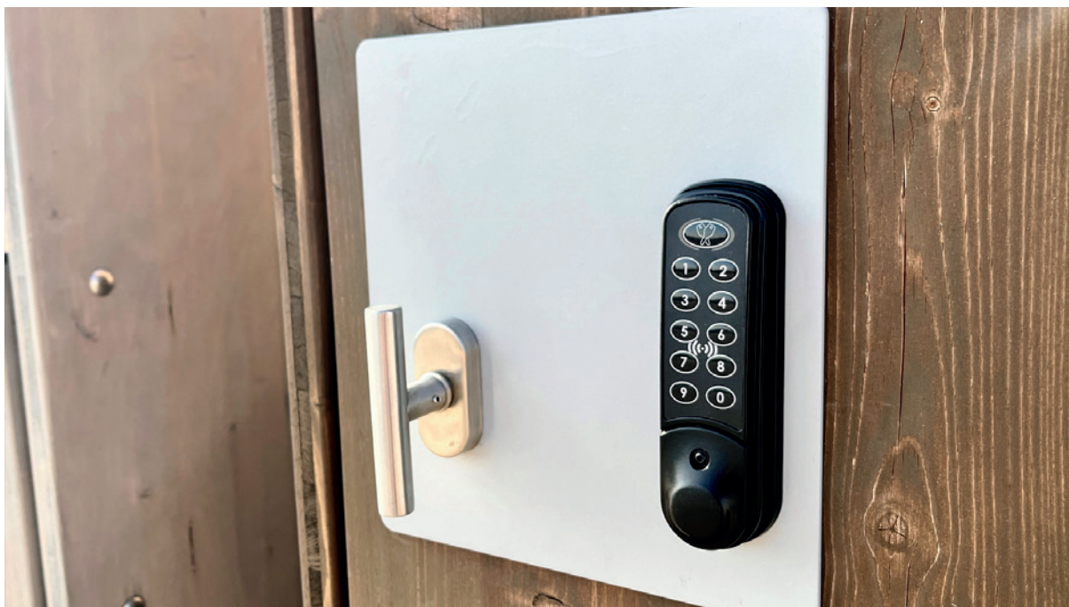
Elektronický zámek - jde o bezobslužný systém, zámek se uzamkne zadáním čtyřmístného číselného kódu.
