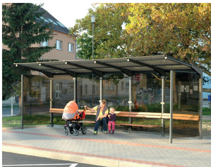
pro lepší ochranu proti slunci mohou být výplně z kouřového skla, které pohltí až 40% tepelného záření
