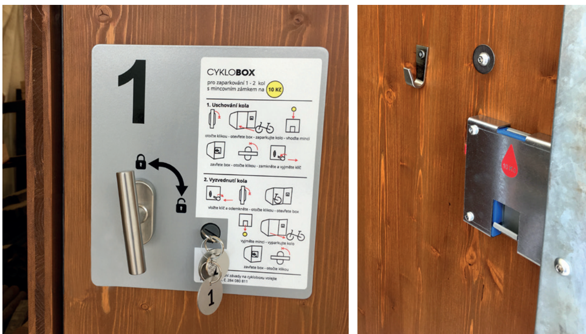
Mincovní zámek - jde o bezobslužný systém, klíč nelze vyjmout bez vhození mince. Uživatel zaparkuje kolo do boxu, vhodí požadovanou minci, uzamkne a vyjme klíč. Po návratu vloží klíč, odemkne a vyjme minci. Standardně na mince 10 Kč (nebo 1 Eur), na objednání dodáme i na mince 20 Kč.
